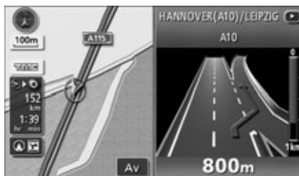
● Vägledningsskärm för motorvägskorsning
