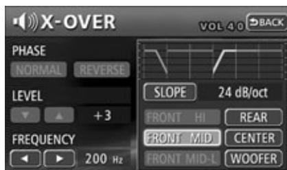
5 Effleurez **SLOPE** pour sélectionner la pente.
