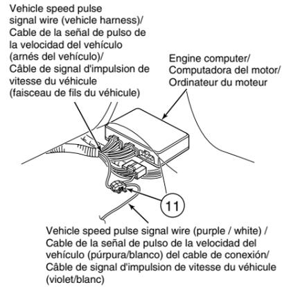
Point de connexion du signal d'impulsion de vitesse du véhicule (exemple)
