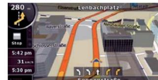
In presenza di strade o svincoli con più corsie, il navigatore indica con una freccia la corsia in cui posizionarsi. Seguendola è possibile guidare in sicurezza anche nelle situazioni più difficili.
