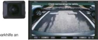
Die Rückfahrkamera BEC108 kann als Einparkhilfe an die AVN-Systeme angeschlossen werden.
