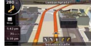
Bei mehreren Fahrspuren wird immer die optimale Fahrspur durch einen Pfeil angezeigt. So sind Sie stets auf Spurwechsel und Abbiegen vorbereitet für ein flüssigeres und komfortableres Fahrerlebnis.
