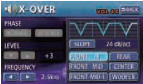
调节交迭点的频率，利用“slope(倾斜)”，从带通下降至6/12/18/24dB/octave，并设定电平。
