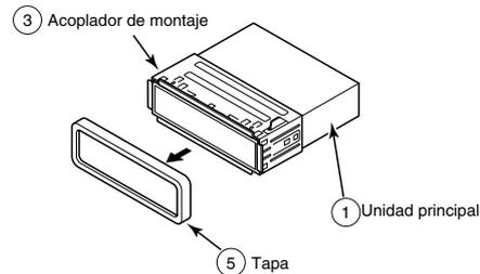
**2** Inserte la herramienta para extraer la unidad de audio en los laterales derecho e izquierdo de la unidad principal y desconecte la cerradura del acoplador de montaje.
