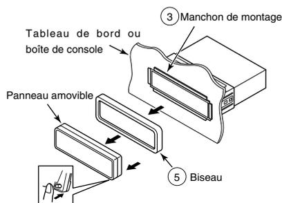
3 Insérez l'outil de dépose de l'unité audio sur les côtés gauche et droit de l'unité principale, et libérez le verrouillage du manchon de montage.
