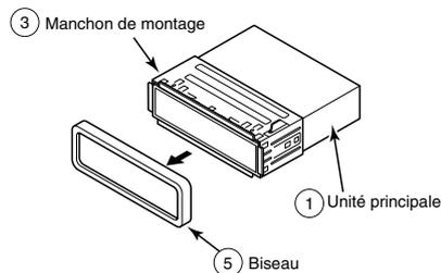
**2** Insérez l'outil de dépose de l'unité audio sur les côtés gauche et droit de l'unité principale, et libérez le verrouillage du manchon de montage.
