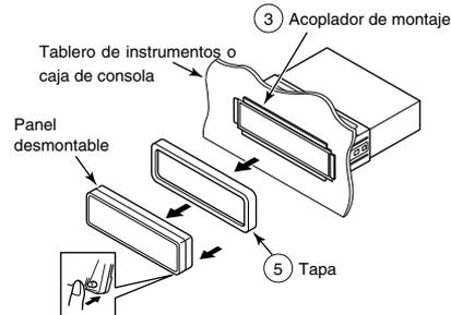
**3** Inserte la herramienta para extraer la unidad de audio en los laterales derecho e izquierdo de la unidad principal y desconecte la cerradura del acoplador de montaje.
