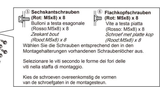
Befestigungsschrauben / Bulloni di montaggio / Bevestigingsbouten
