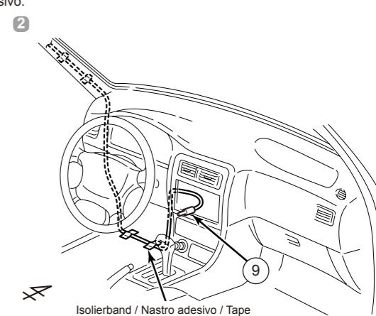
♦ Installation der GPS-Antenne /
