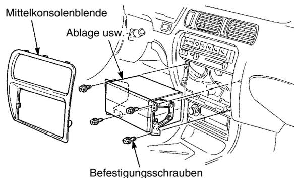
■ Installation des 2DIN-Installationssatzes (separat erhältlich)
