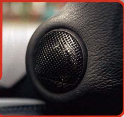
Die Hochtöner an den A-Säulen sorgen für gute Bühnenabbildung
