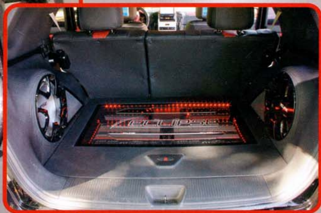
Für die Endstufen unter Plexi wurde ein eigenes Belüftungssystem installiert
