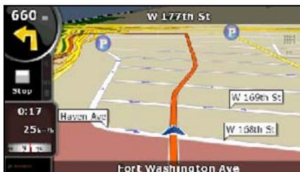
La qualité de positionnement GPS est affichée dans le coin inférieur gauche. Plus il y a de barres allumées, plus la qualité de positionnement GPS est précise.
