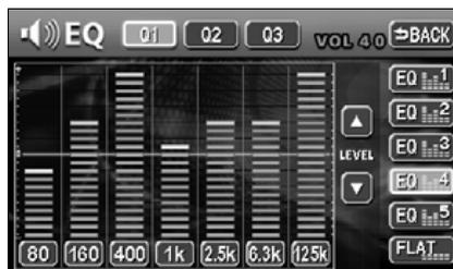
**3** Effleurez la touche **Q1**, **Q2** ou **Q3** pour sélectionner une courbe Q.
