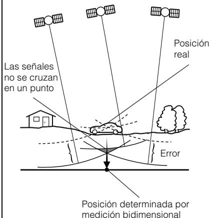
El GPS calcula su posición utilizando un principio de medición de 3 puntos.
