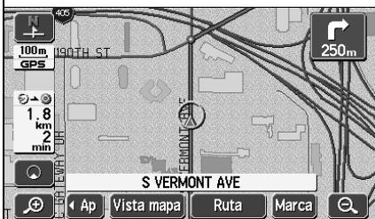
Las señales proceden de 3 o más satélites GPS con el fin de determinar exactamente la posición actual de su vehículo. El dispositivo indicará mediante un icono **GPS** en la esquina superior izquierda de la pantalla de la ubicación actual de su vehículo, si está recibiendo señales de 3 o más satélites y, por lo tanto, si el posicionamiento es posible. (El icono **GPS** no aparece en las pantallas de ajuste o registro.)
