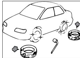
Cuando cambia al menos un neumático, el icono de posición del vehículo se puede desalinearse.
